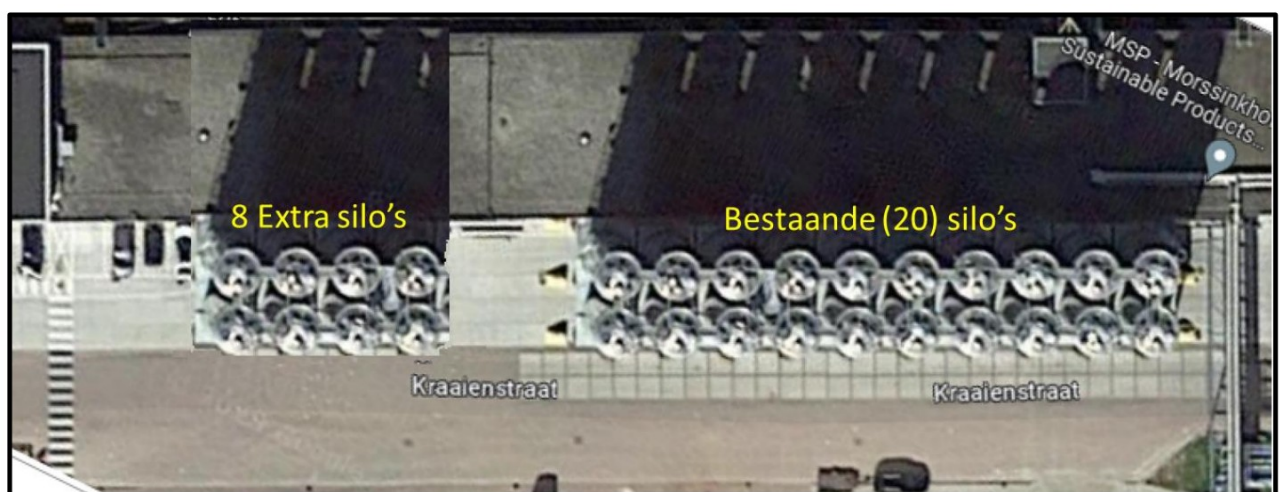
Fig. 1: Locatie van de 8 extra silo's in het verlengde van de bestaande 20 silo's tegen de zuidwand van het gebouw op perceel F14653.
